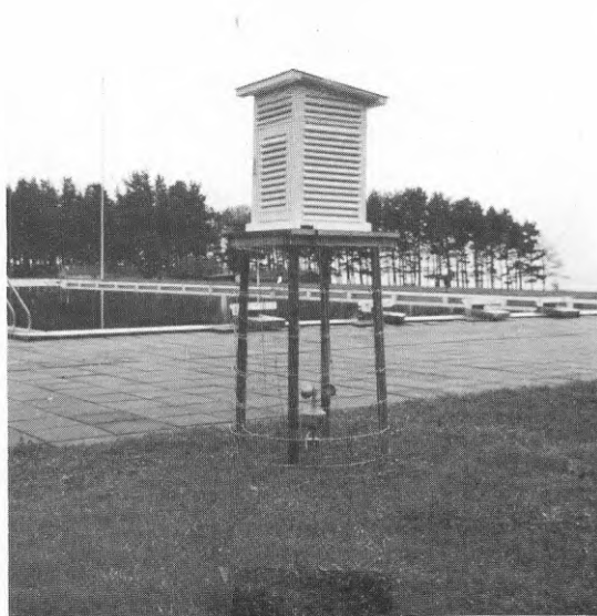
Fig 2.3 Termometerbur innehållande temperaturgivare för lufttemperatur samt hygrometer. Under denna placerades kontaktanemometern.
