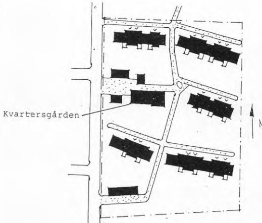
Figur 3.1. Bostadsområdet Tuggelite. Solfångarna utgör större delen av det sydvända taket på kvartersgården i mitten, där även värmecentralen är placerad.
