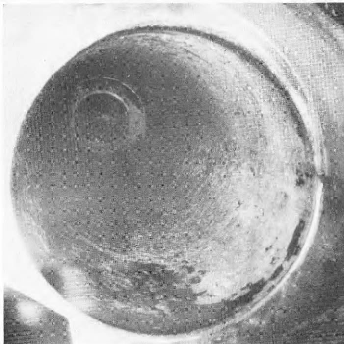
Fig. 6.1. Beläggning på värmeväxlareytan efter 6 månaders drift.
