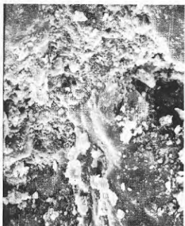
Figur 10. Medelsvår smuts på tegel i 500 ggrs förstorning
