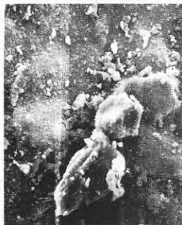
Figur 11. Svår smuts på tegel i 500 ggrs förstorning
