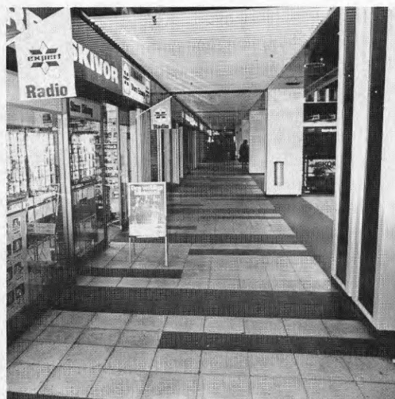
Bild 23.3. Skylt- och reklamställ var placerade i förflyttningväg. Reklamflaggor hängde på låg höjd utanför butikerna. För synskadade kan detta medföra onödiga olycksrisker.
