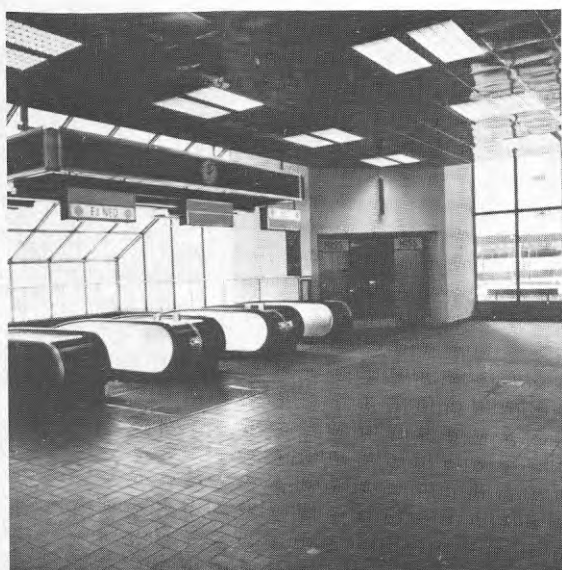
Bild 22.3. Biljetthallen var ljus och lättöverskådlig. Nackdelen med stora glasytor är att ljusreflexer ibland försvårar orienteringen för synskadade.
