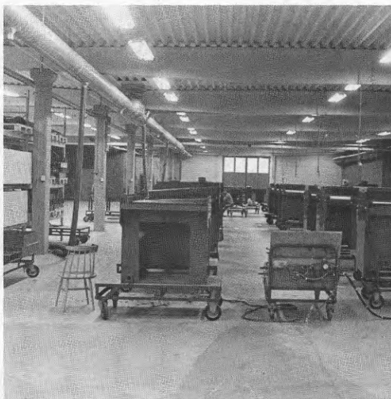
Bild 15.7. Låga maskiner gav god överblick i verkstadslokalen. Belysningen var god i lokalen. Passageytorna var väl tilltagna, vilket är bra både för synskadade och rörelsehindrade personer. Pearlarna i orange färg framträdde tydligt mot den grå bakgrunden.
