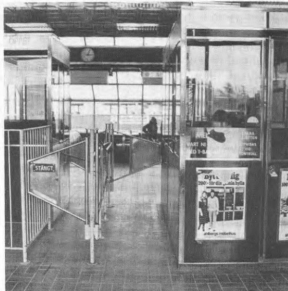
Bild 22.2. För barnvagnar och rullstolsbundna personer hade en något bredare spärr ordnats. Vakten måste lämna kassan för att låsa upp en bredare grind om denna inte är tillräcklig.
