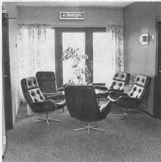
Bild 13.6. Tunga möbler blockerade nödutgången. Vid utrymning skulle handikappade få speciella svårigheter att ta sig ut. Nivåskillnaden utanför var också farligt stor vid den här nödutgången.
