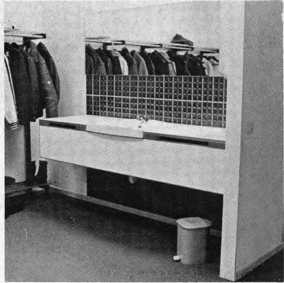
Bild 21.10. Personalens "snyggningshörna" var utformad så att den inte kunde användas av rullstolsbundna. Tvättbänkens front och höjdplacering gjorde att blandaren var svår att nå. Spegeln var placerad för högt för rullstolsbundna.
