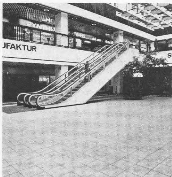
Bild 23.5. Rulltrappan var fritt placerad i köpcentrumets hall. Man kunde passera under den. För synskadade medför en sådan lösning olycksrisk.
