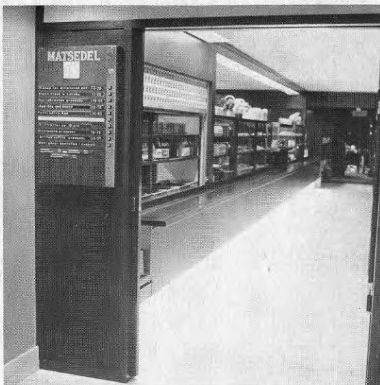
Bild 13.5. Restaurangens självservering hade knappsystäm för matbeställning. En rullstolsbunden skulle inte kunna nå knapparna och skulle ha svårt att själv klara detta självserveringssystem.
