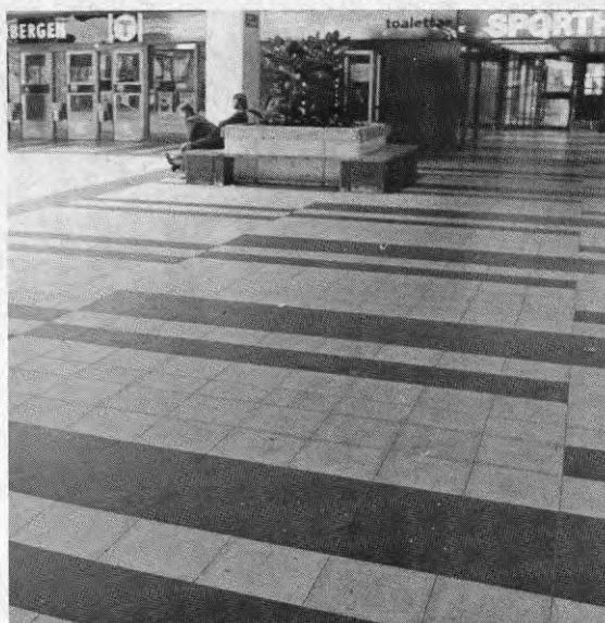
Bild 23.2. I köpcentrumets nedre hall fanns sittplatser. De mörka bänkarna framträdde dåligt mot golvet's mönster. För synskadade kan de därför vara svåra att upptäcka i tid.
