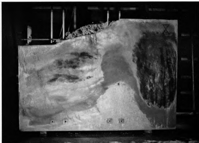
FIG 5.29 Monolit 10. Gjutuppehåll - retarder. Satsernas gjutordning: Ofärgad, röd, gul, svart, ofärgad, röd, gul, svart.
