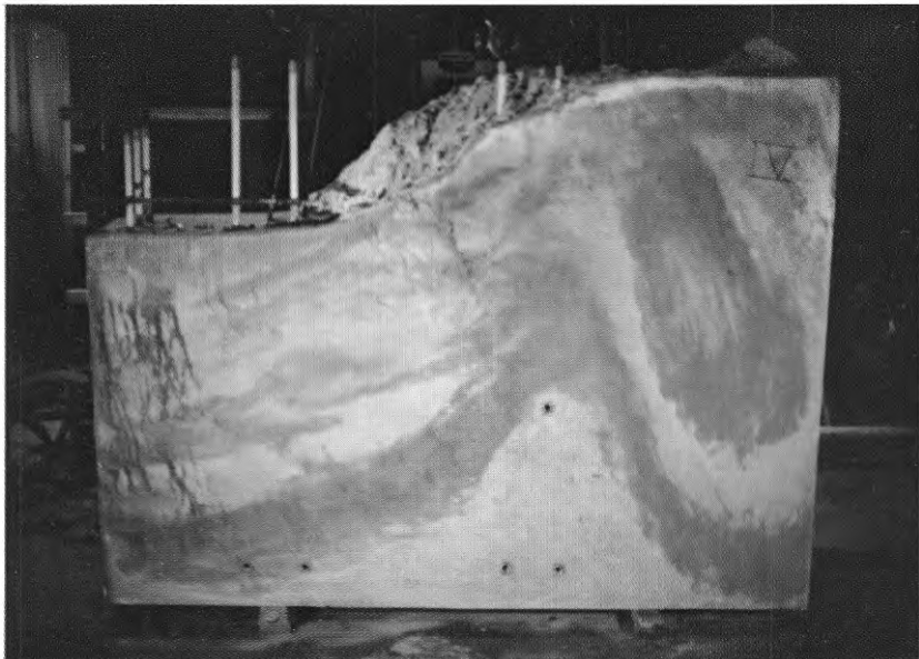
FIG 5.24 Monolit 4. Hög stighastighet. Satsernas gjutordning: Ofärgad, röd, gul, ofärgad, röd, gul, ofärgad, röd.
