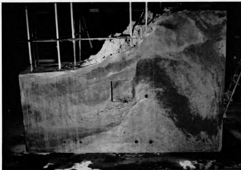
FIG 5.21 Monolit 1. Satsernas gjutordning: Ofärgad, röd, gul, ofärgad, röd, gul, ofärgad.
