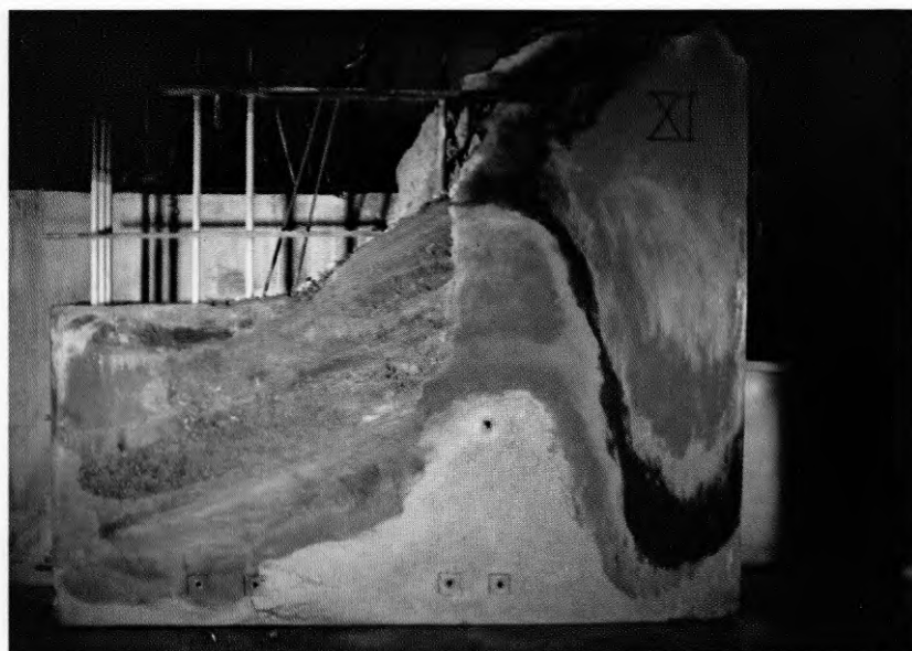
FIG 5.30 Monolit 11. Grovt grus. Satsernas gjutordning: Ofärgad, röd, gul, svart, ofärgad, röd, gul, svart.
