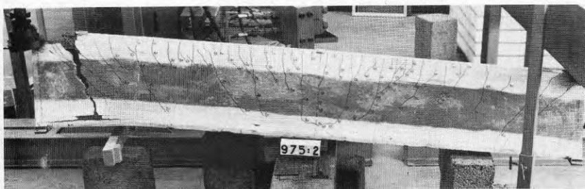
FIG. 4.5.3:5 Triangelbalk II efter brott
