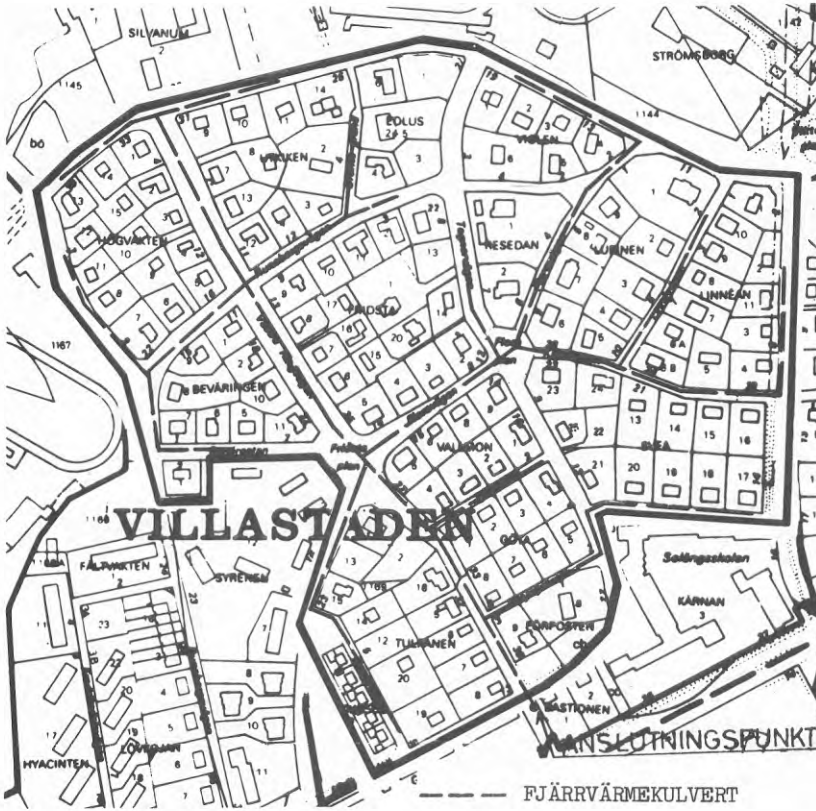
FIG 21 PLANERAT KULVERTNÄT VID FJÄRRVÄRME
