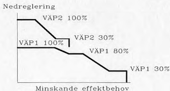
Figur 3.10 Nedreglering av kompressorkapacitet.
