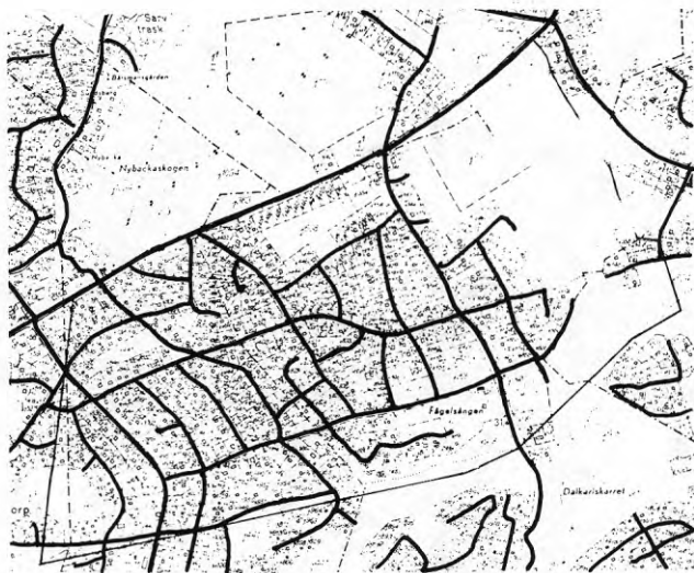
FIG 6 Äldre trafiknät med låg grad av differentiering och separering.
