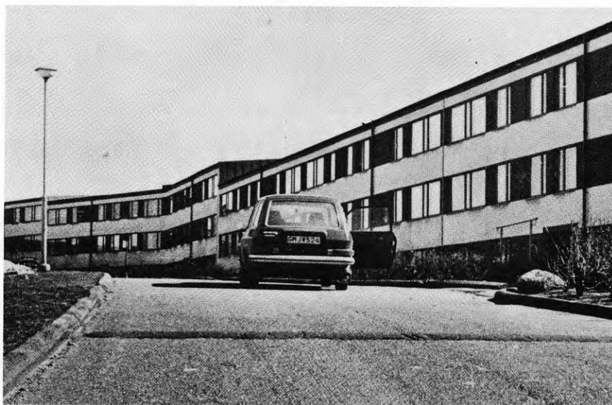
FIG 20 Kantsten tvärs över körbanan för att hålla hastigheten nere. Skogås, Huddinge.
