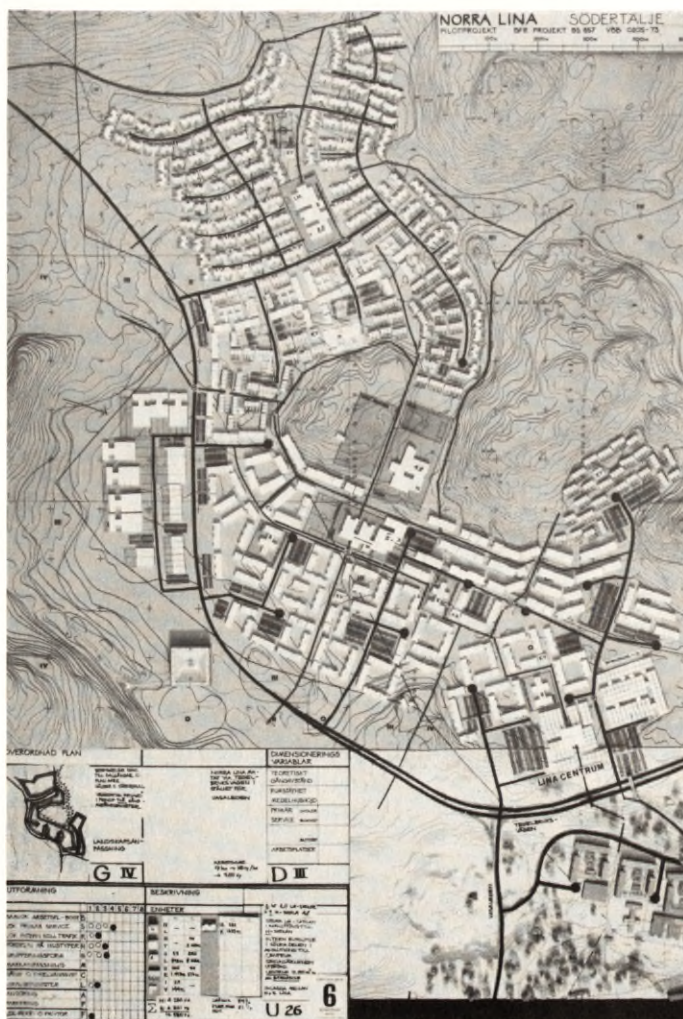
Fig 4.6.1-2 Fotoplan från systematiskt modellarbete framställt i skala 1:2000 från modell i skala 1:1000, Norra Lina, Södertälje. Södertälje stadsarkitektkontor ark Per Kallstenius 1972.
