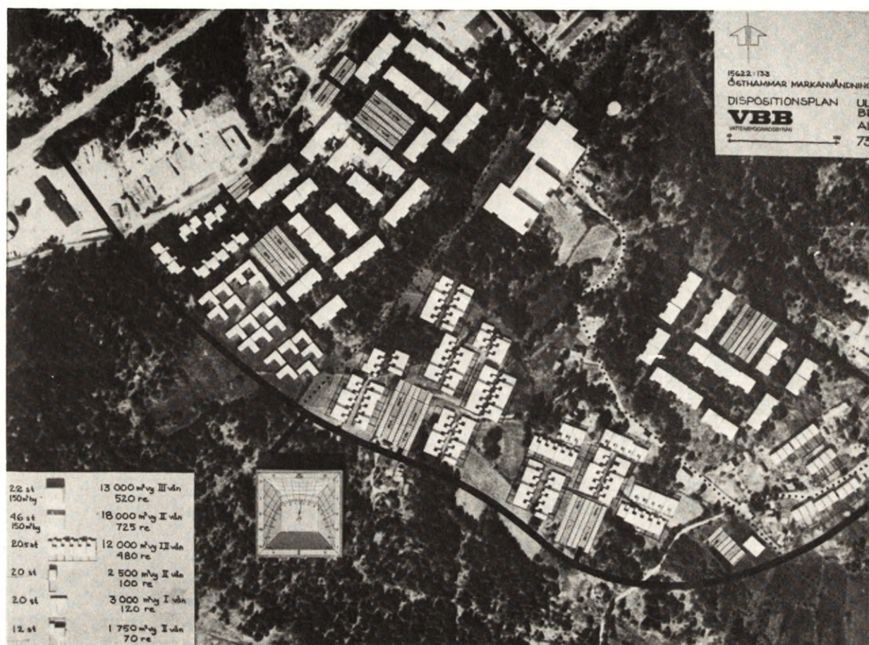
Fig 4.4.2-1 Exempel på studie av ramalternativ på flygfotounderlag i skala 1:1000 som underlag för markanvändningsplan. Östhammars generalplan, VBB 1973.
