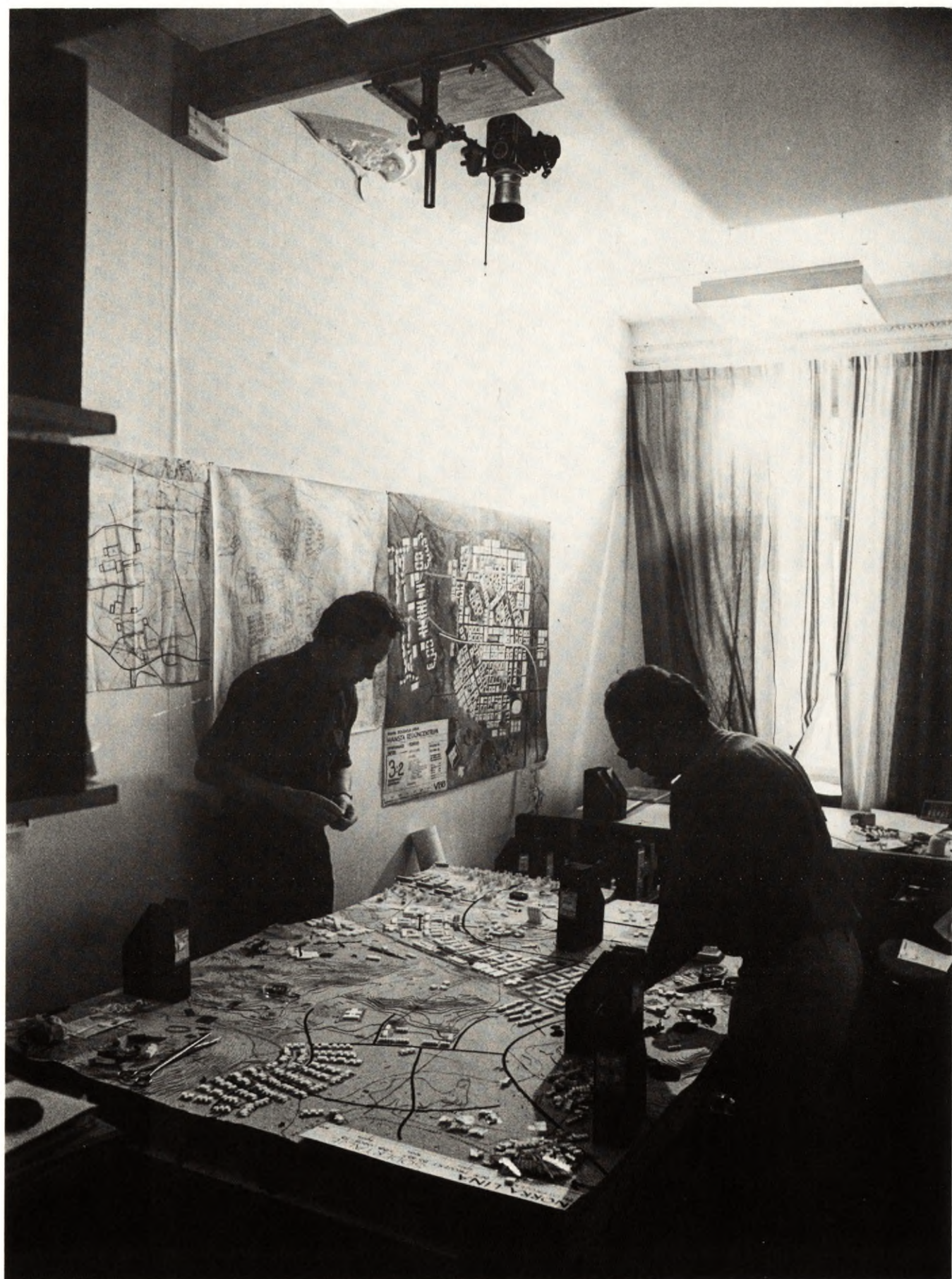
Fig 4.3.4-1 Modelluppställning för större planmodell i skala 1:1000, format 150 x 170 cm, fri takhöjd i rummet 320 cm.
