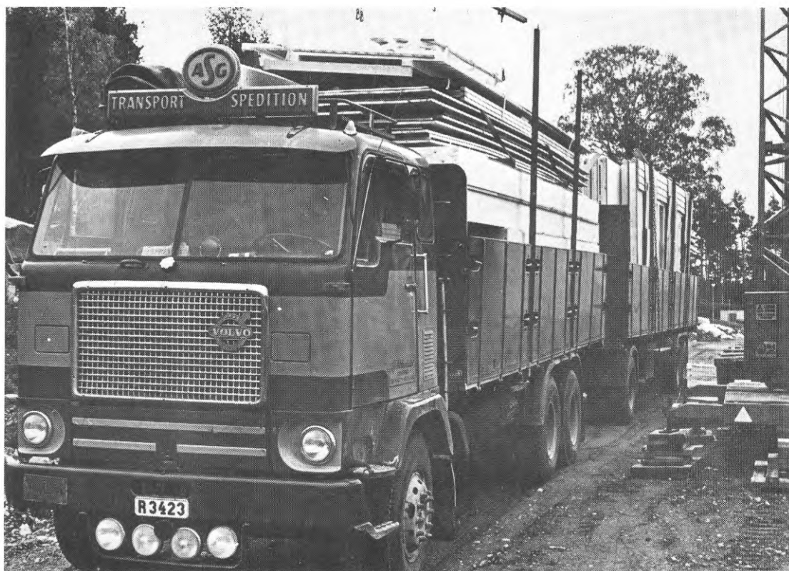
Standarddragfordon med släpvagn med 64 huselementdelar för ett tvåvånings radhus färdigt för monteringsstart
