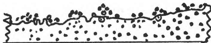
Fig. 72e. Kraftig kritning, hela ytan täckt av pigmentkorn fria från bindemedel.
