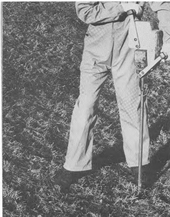
Foto nr 1. Borrning med jordspett.
