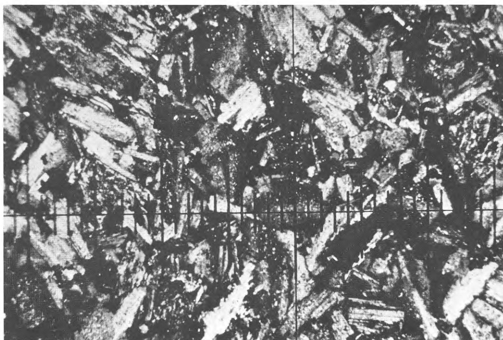
Fig. 4 Mikrofoto av diabas. 10 skalstreck = 0,5 mm.
