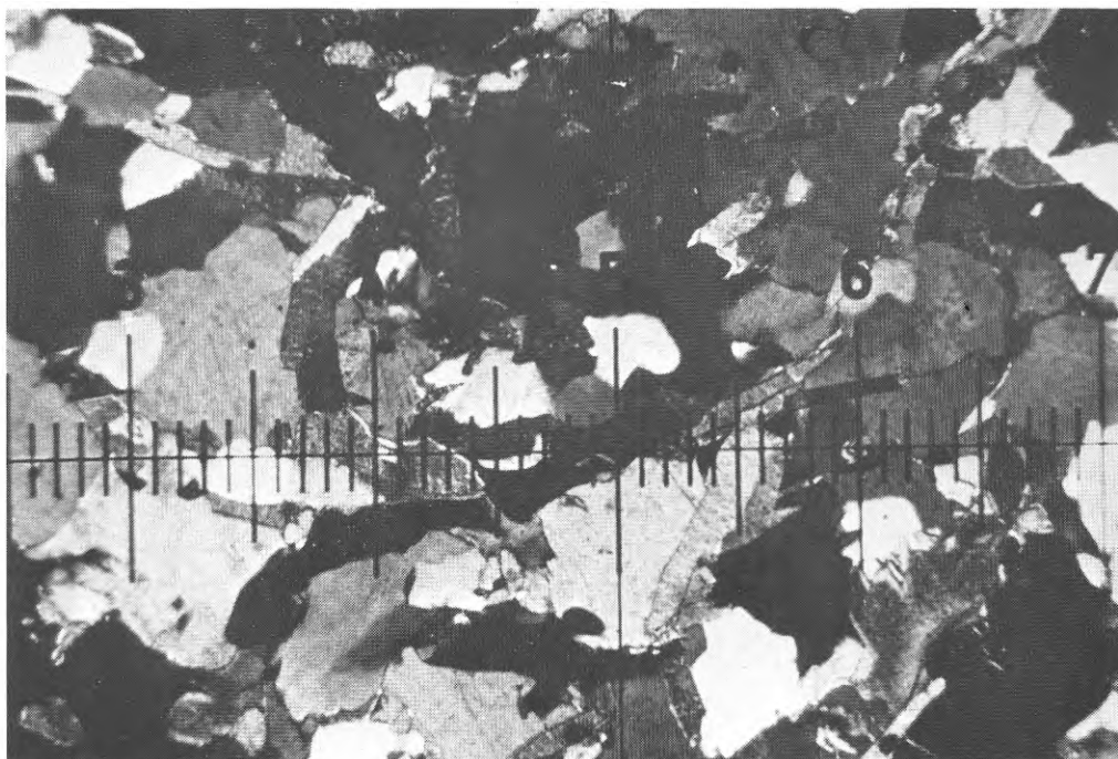
Fig. 3 Mikrofoto av finkornig granit. 10 skalstreck = 0,5 mm.
