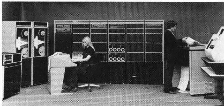
↑ SKIVMINNE ↑ MAGNETBANDSTATIONER ↑ CENTRALENHET (DATOR) ↑ RADSKRIVARE ↑ KORTLÄSARE ↑ KONSOLSKRIVMASKIN ↑ REMSLÄSARE ↑ REMSTANS DECTAPES
