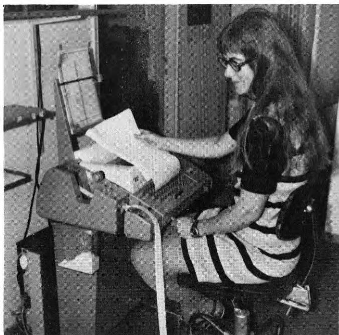
FIG 9.5.2-1 Skrivmaskinsterminal med remsstans och remsläsare Bakom maskinen ses telemodem
