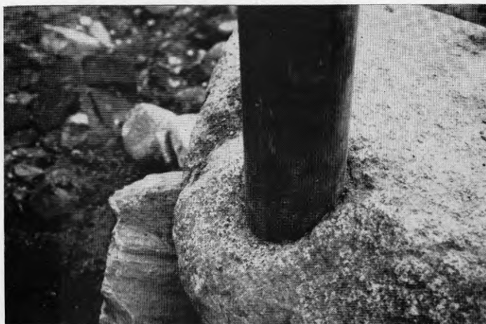
b) Detalj av foderröret i stenblocket. Som synes har stenblocket inte ens fått en spricka på det svagaste stället, där måttet till kanten är endast 11 cm.
