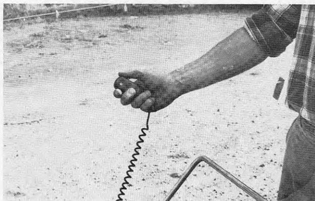
Figur 415 Antennen är försedd med en signalknapp (marker), som vid signal ger markering (registrering) i diagrambanden hos skrivaren och samtidigt också hos bandspelaren, om denna är i gång.
