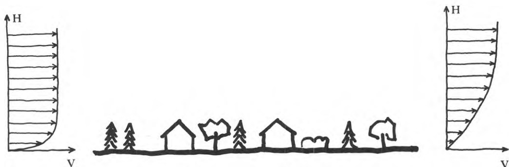
Fig. 11. När luftströmmen passerar hinder på marken bromsas det nedre luftskiktet upp.
