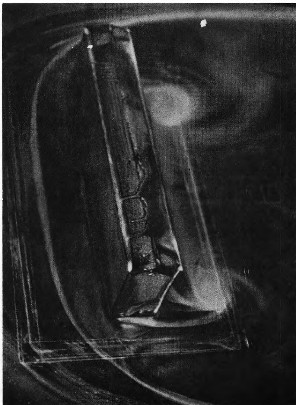
Fig. 14. Modellförsök i vindtunnel. Färgen samlas i läzoner.
