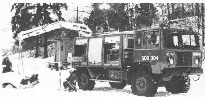
SDB 304 i aktion. Brandmännen Lars-Olof Andersson och Ake Holmberg (4) har först skumbejuttet krockbilen med uttag från bilen, sedan manövreras lyftkranen medelst en bärbar manöverpanel. Snabbt och lättvändig. Foto: Ove Andersson.
