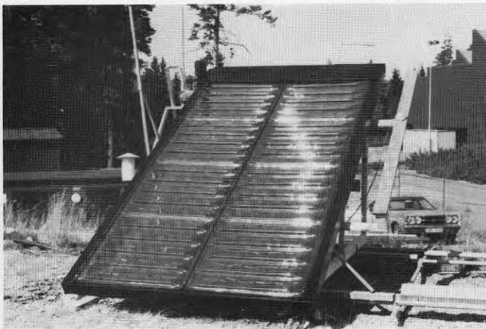
Bild 5 - Scandinavian IT provningssolfångare på Statens Provningsanstalt
