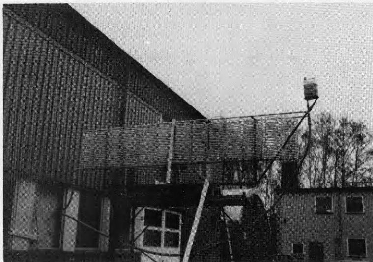
Fig 3.24 Lätt påfruset cylinderstaket
