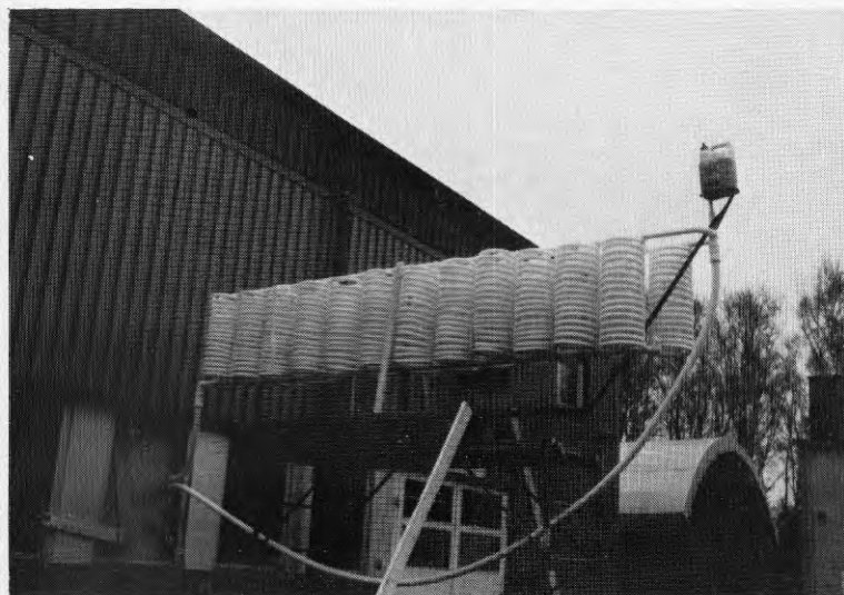
Fig 3.25 Kraftigt påfruset cylinderstaket
