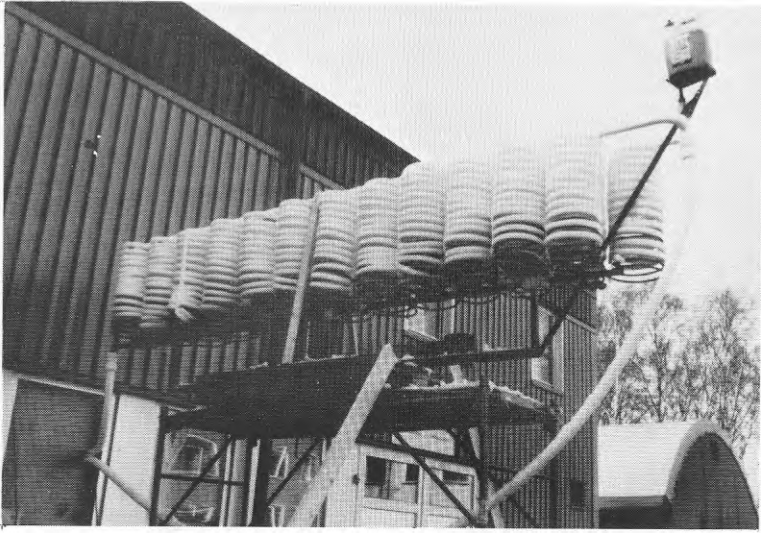
Fig B3.11 Avfrostning av cylinderstaket.
