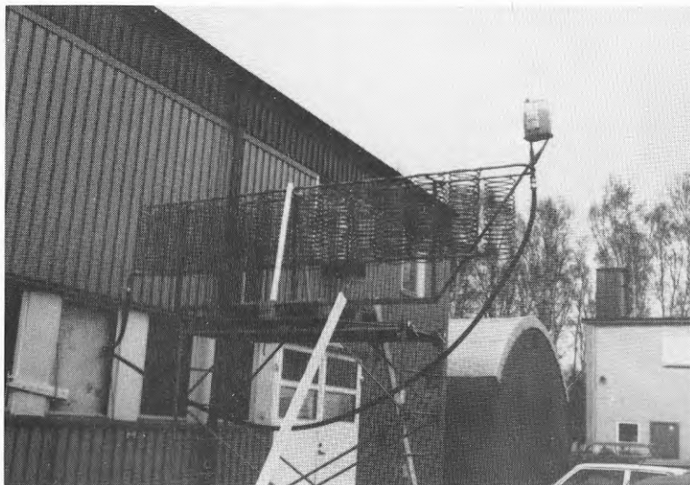
Fig 3.23 Ej påfruset cylinderstaket
