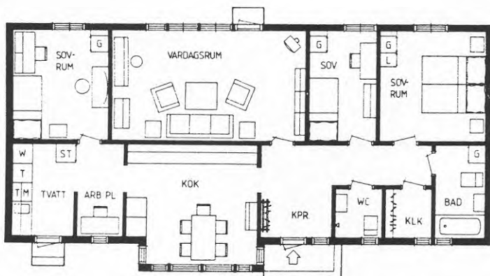
Figur 6 Planlösning för "Borovillan" med 106 m 2 primär bruksarea.
