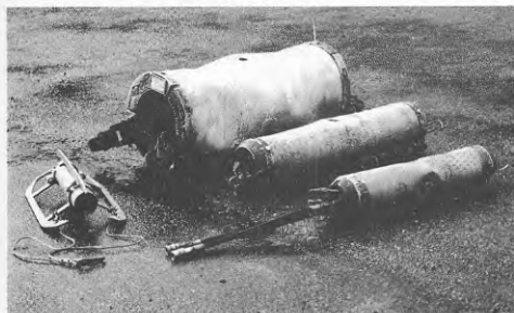
Figur 3.3.2 Tryckhuvuden med 3 st separat uppblåsbara element (manschetter) för dimensioner \emptyset 150-700 mm.
