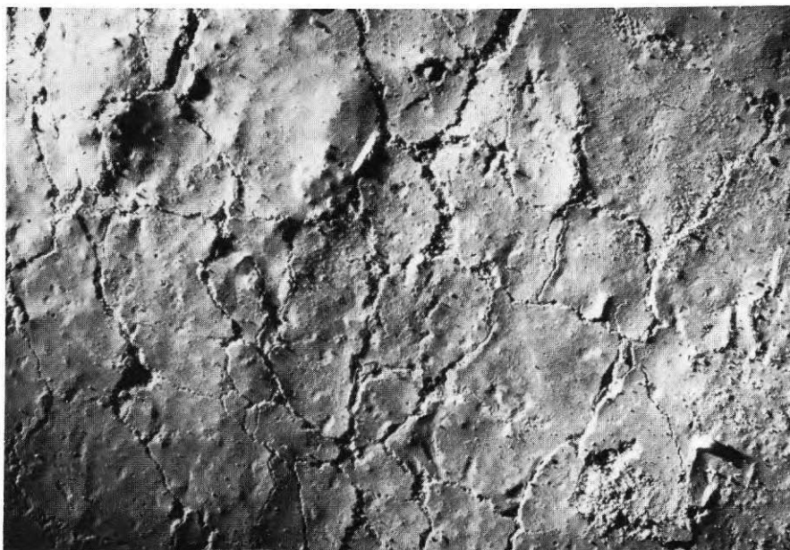
FIG.8. Betongyta utsatt för ren \text{CO}_2 under 9 dygns härdning. Kraftig krackelering uppstår i karbonatskiktet. 2 X.
