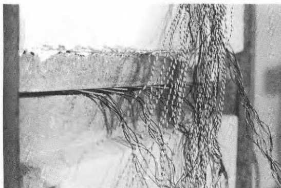
Figur 7.5 Kännare för registrering av vattenläckage monterade i horisontalfogen. När vatten tränger förbi fogtätningen sker kortslutning mellan trådändarna.
