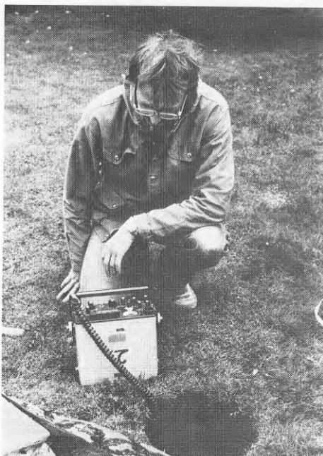
Figur 4.5 Mätning med gammaspektrometer i spadborrat hål.
