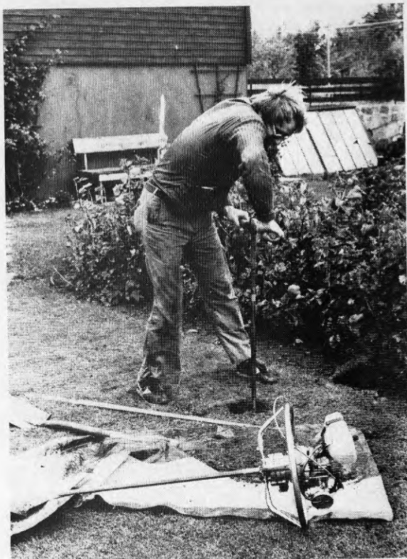
Figur 4.3 Spadbörning i morän. I förgrunden den bormaskin som använts för att göra hål i marken för mätning av radon i jordluft med emanometer.
