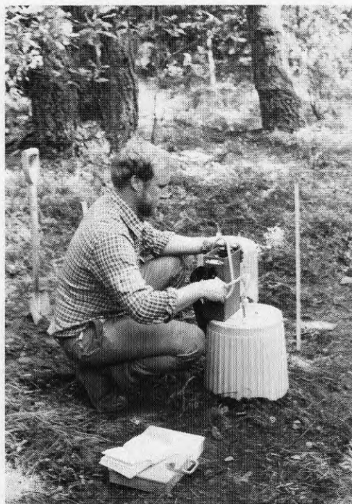
Figur 6.6 Provtagning med emanometer ur behållare för uppsamling av radon, som avgår från en hällyta.
