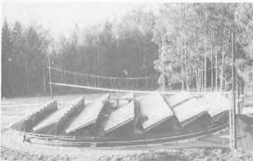
d) Dubbel parabolisk (CPC) solfångare på roterande plattform (Studsvik solvärmecentral)
