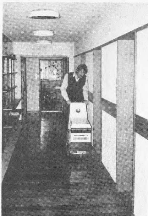
Fig 3:258 Polering av Kork- O-Plastgolv med High Speed-maskin
