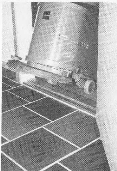
Fig 3:72 Passage med kombi- maskin över trös- kel till städrum Maskinen måste lyftas över trös- keln
