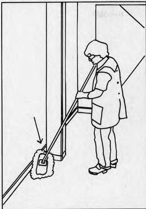
Fig 3:15 Fristående pelare i korridor Utrymmet mellan pelare och vägg är för smalt för att komma emellan med mopp eller mopptruck
