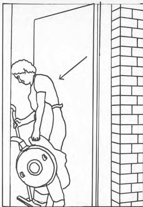
Fig 3:33 Branddörr med hårt spänd dörrstängare Denna är tung att öppna och hålla öppen medan städa- ren passerar med sin utrustning, städmaskin, städ- vagn och dylikt
