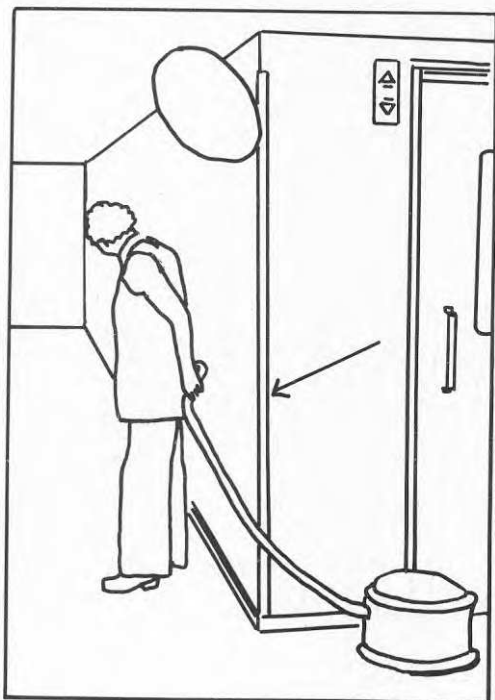
Fig 3:78 Vägghörn i korridor skott med skyddslist
