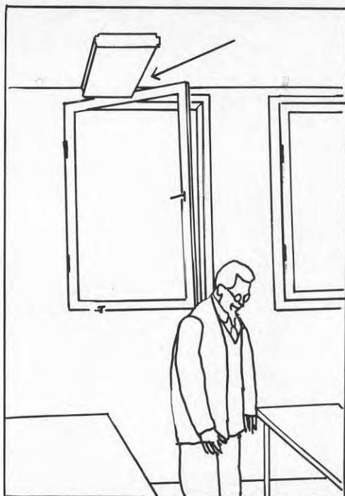
Fig 3:58 Inåtgående fönster i kontorslandskap Lågt sittande tak- armatur begränsar fönstrets öppnings- vinkel vid fönster- putsning
