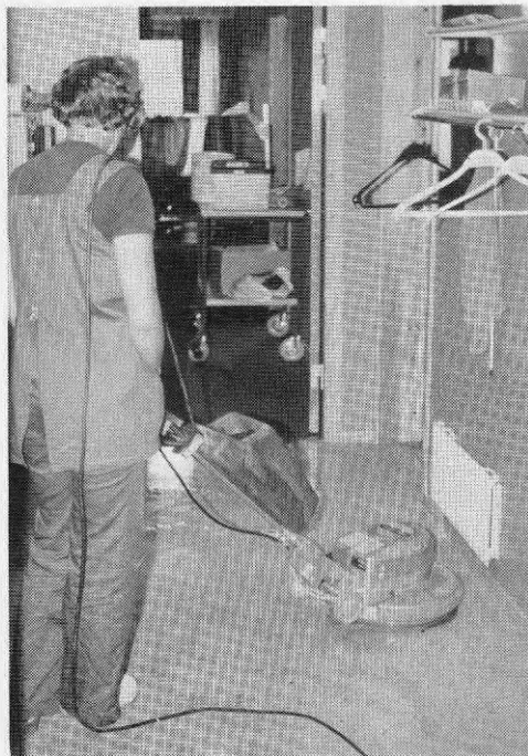
Fig 3:254 Skurning av golv med golvvårds- maskin (enborst)
