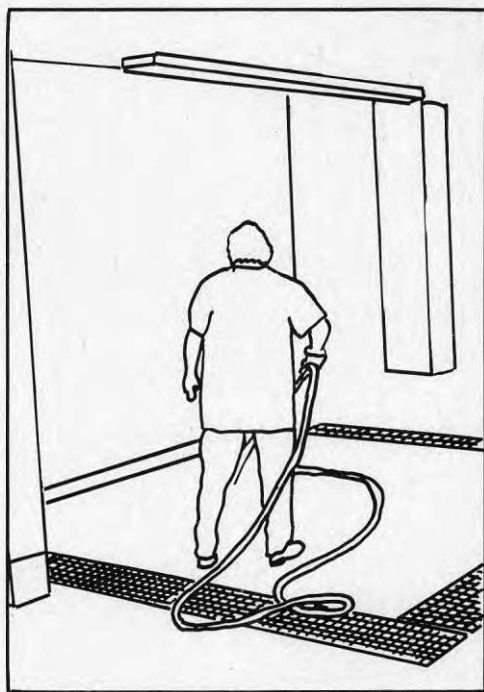
Fig 3:194 Spolplats för matvagnar inramad av golvbrunnar
