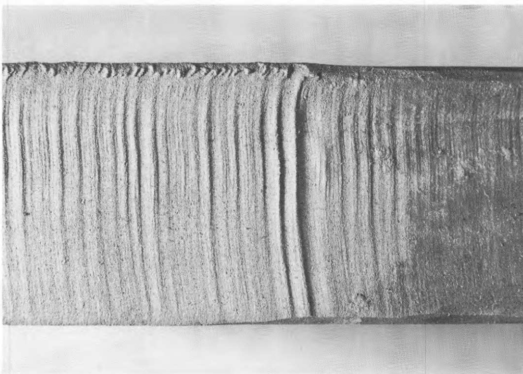
Fig 4 Termiskt skuren sandblästrad stav med lokalt räffeldjup av 0,45 mm provad genom dragutmattning mellan 5 och 34 kp/mm 2 . 2,3 x 10 6 antal lastväxlingar utan brott. Anvisningen har stor bottenradie vilken verksamt bidragit till att utmattningshållfastheten ej blivit nedsatt
