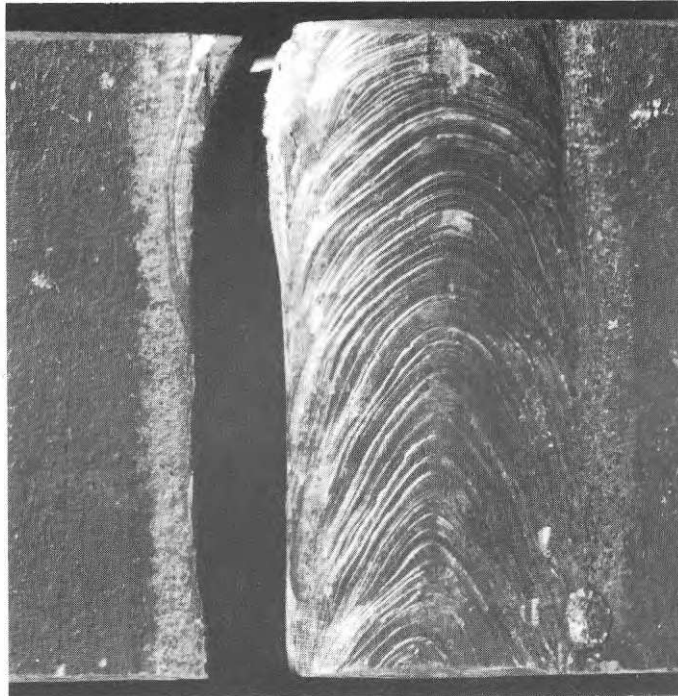
Fig. 4 Stumsvets med zirkonbasisk högutbyteselettrod i Stål 36.
