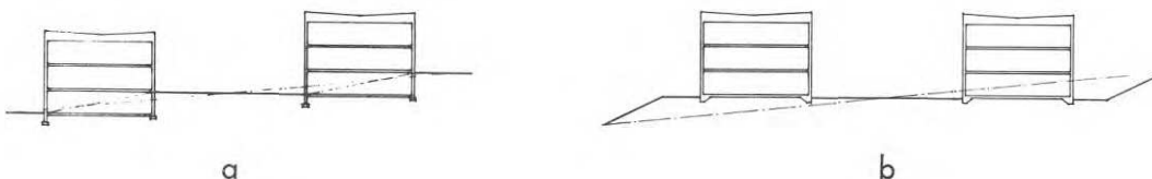
Fig. 2. Olika sätt att ta upp nivåskillnaden a) i husen b) utanför husen.
