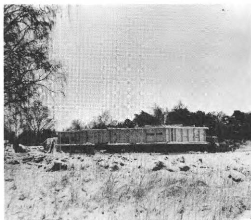
Fig. 15. Lasten utgjordes av en grusfylld trälåda. The load was a gravelfilled woodenbox.
