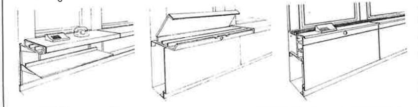
Fig 28. Kontorsinredning med samtidig funktion att dölja bl a lättåtkomliga elledningar.
