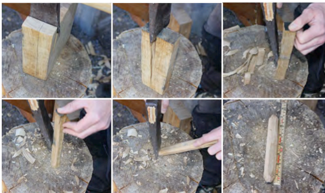
Figur 71. Tillverkningen av dubb gjordes likvärdigt för alla dubb och enligt Holmbergs beskrivning. Ämnet till dubb valdes utifrån ek som var rakfibrig och kvistfri. Först avsattes måtten på ämnet där dubben skulle tass ut ifrån. Här gjordes tillägg på 5 mm på var sida för att ha övermån vid spräckningen. Spräckningen gjordes med timmeryxan och en handslägga som knackades på yxans nacke. Sedan högs
