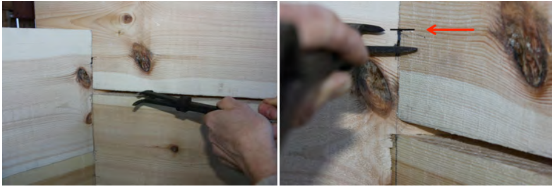
Figur 80. Likvärdigt för påritning av hakets bakkant blev det för laxknuten Alt. 3. Här syntes dock skillnaden mellan underhaket och överhaket, vilket gjorde att mejnan kunde användas för att sätta av en markering. Den bands sedan samman med mejningen av knutens ytterhörn.
