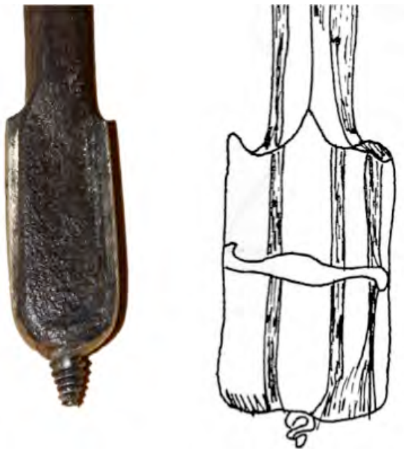
Figur 16. T.v. Navaren (25 mm) som användes i studien och T.h. Holmbergs illustration av axnavare (Nm 33 E.U. 2578, Tilläggsblad s. 135). I hustimringstexten (Nm 11 E.U. 2579) anges oxnavare i sammanhanget, antingen har det blivit en felskrivning i något av bladen eller så avses olika.
