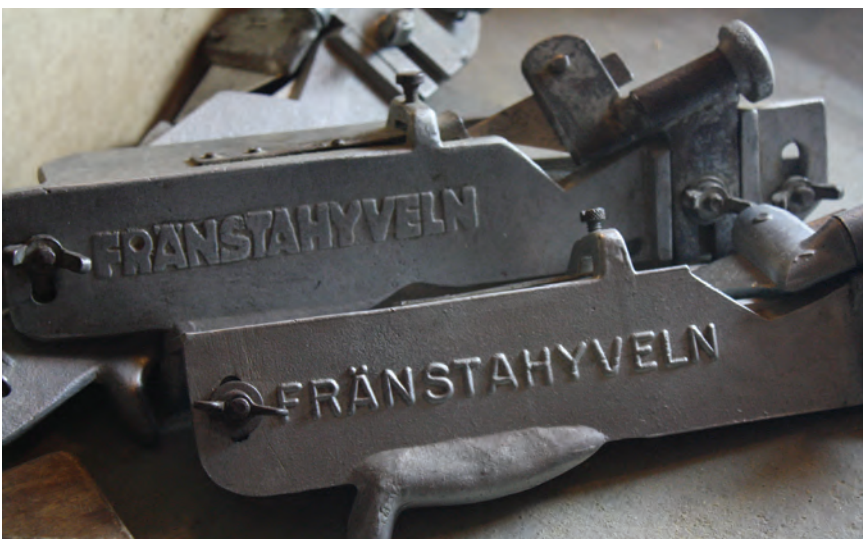
En typ av hyvel som historiskt använts för att hyvla kanterna på masonit var Fränstahyveln, vilken kan åstadkomma olika breda faser beroende på hur stålet vinklas.
