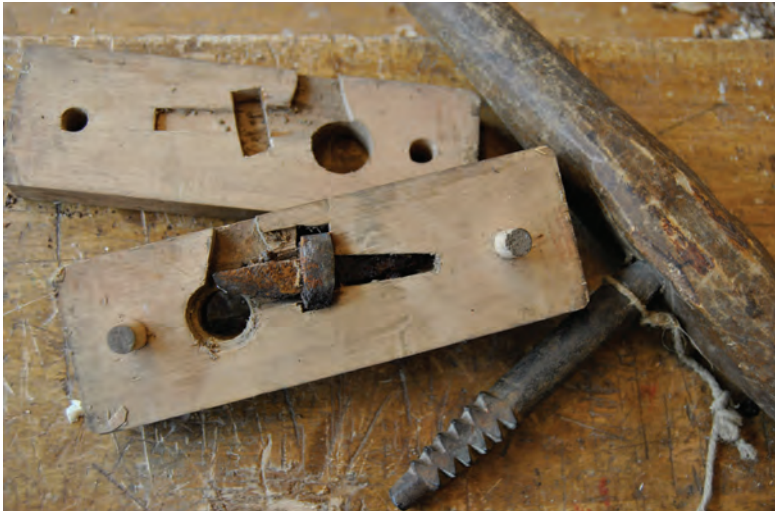
Bild 2. Ett snedtyg består av två sammanfogade träklossar tillverkade i ett hårt träslag, vanligtvis björk. Klossarna är försedda med centerade hål som är borrade vinkelrätt mot klossarnas kontaktyta. Klossarna kallas här för huvuddel och styrdel. Hålet i huvuddelen har försetts med invändiga gängor, tillverkade av en gängtapp. Inne i huvuddelen sitter ett v-format stål fixerat, en så kallad getfot, som skär de utvändiga gängorna på skruvämnet.
