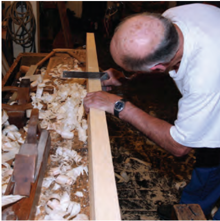
Bild 8. Därefter kontrolleras samma kant med en anslagsvinkel.
