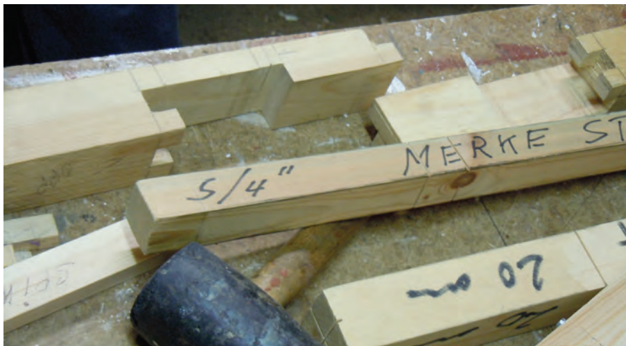
Billede 4. Den mærkestav som Oddbjørn anvender til at tilridse alle tømmerensamlingerne. Foto: Nils-Eric Anderson.
