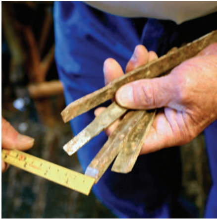
Bild 16. Ett 15 mm brett notstål väljs och nothyveln ställs in i centrum på styckena.
