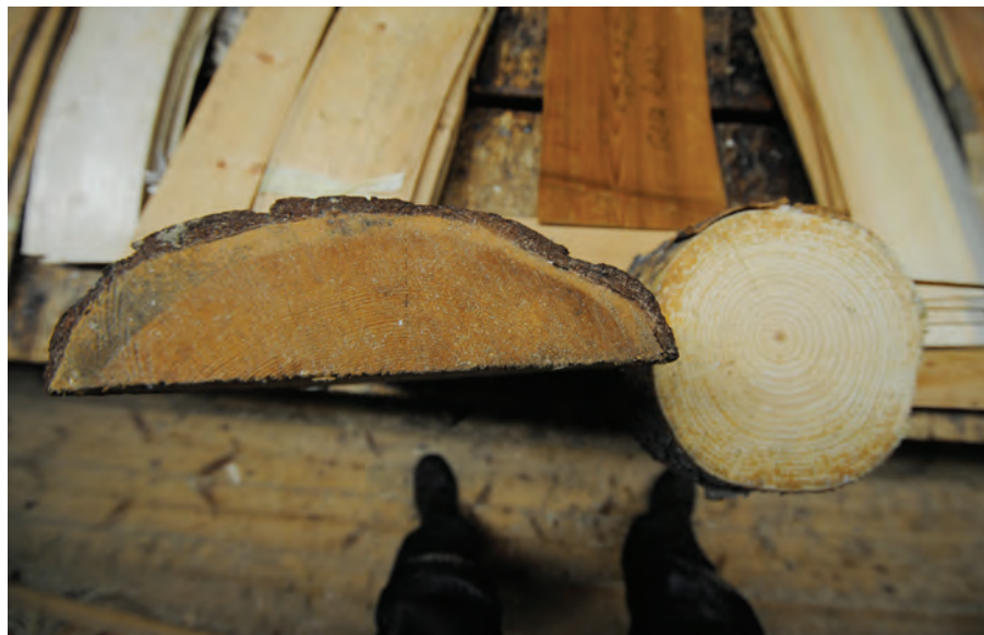
Bild 6. Till vänster en bakdel av en spånkubb av tätvuxen fura med hög kärnandel. Till höger en frodväxt gran. Furan har till skillnad från granen en tydlig uppdelning mellan kärnved och splint.
