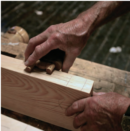
Bild 18. Därefter ritsas markeringen för tapphålerna på sidstyckena. I centrum av tapphålerna görs en rits som styrning för den spiralborr som ska användas. Tapphålerna ska borraras och rensas med stämjärn. Borren är ca 2 mm mindre än det blivande tapphållet.
