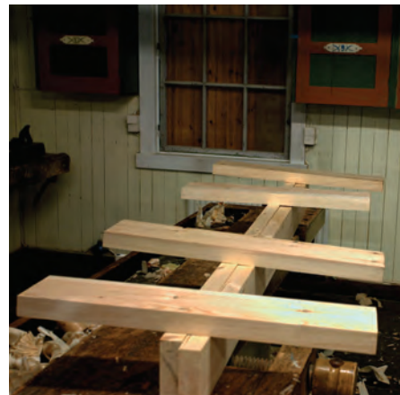
Bild 15. För att göra indelningen för fyllningarna läggs tvärstyckena ut på sidstyckena och tapphålerna för mellanstyckena märks på sidstyckena.
