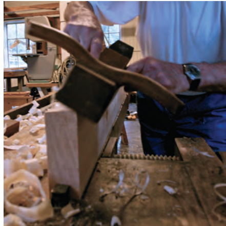
Bild 12. För att slippa att böja sig för att se ritsen vid den fortsatta hyvlingen läggs en fas med oxhyveln ned mot ritsen. Därefter utförs den första avverkningen med oxhyveln för att sedan ta ner det sista till ritsen med en rubank.
