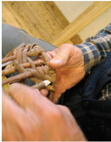
Bilde 23 og 24. Før Georg fortsetter flettingen setter han inn ytterligere to ribber, en på hver side. Han tynner og spisser de litt i endene, så de er enklere å få på plass i rommet/lommen opp mot kantringen.
