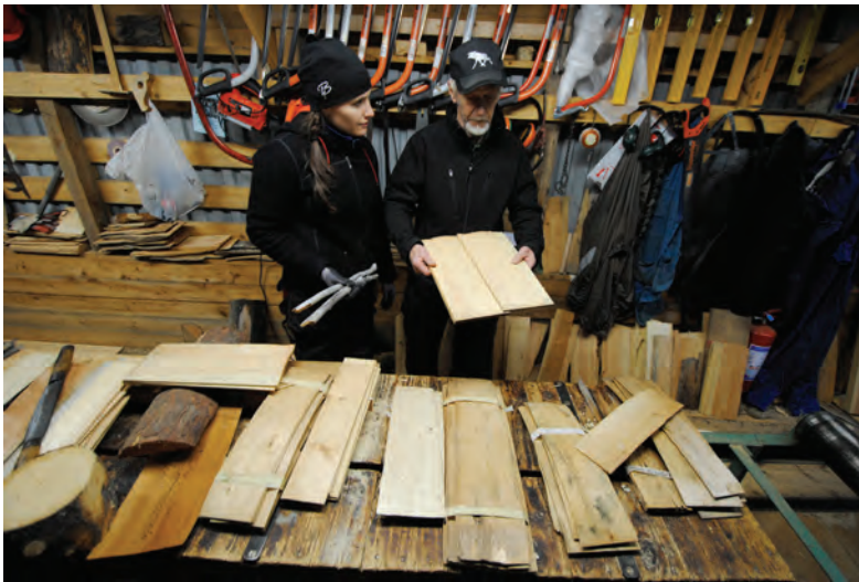
Bild 2 och 3. Maskinhyvlade spån med hög kärnandel (överst). I ena kanten av den färdiga spånans finns en del splintved kvar. Splinten har sämre motståndskraft än kärnveden. Tycho beskriver för mig hur splintveden ska placeras i överlappet i läggningen (nederst).
