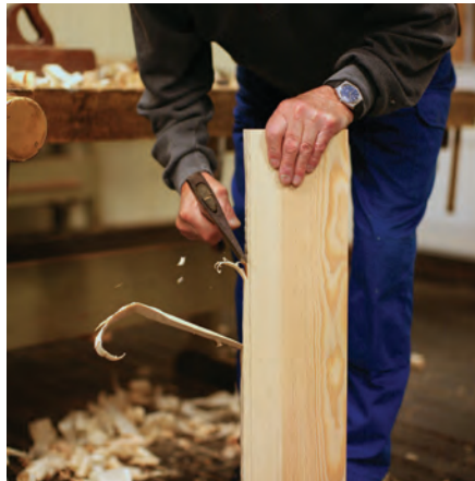
Bild 11. På tvärstyckena anser Sjur att övermättet på ca 15 mm är för mycket att börja hyvla på, därför avverkas ned till ca 2 mm:s övermått med yxa.
