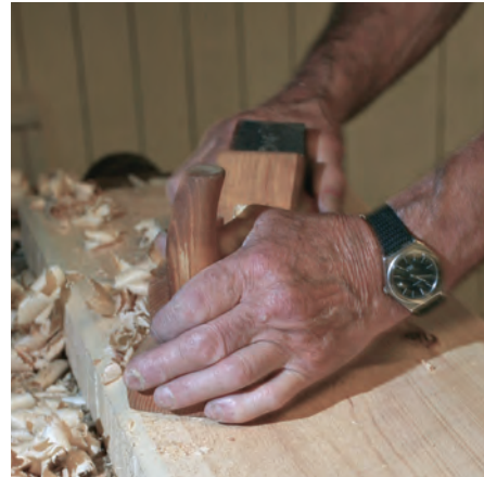
Bild 13. Tjockleksmättet ritsas och nu använder Sjur först en skrubbyvel diagonalt över stycket för grovavverkningen innan oxhyveln tar vid. Skrubbyveln har svagt rundad sula och stål. Även oxhyvlingen inleds diagonalt för att sedan fortsättas längs med stycket ner till ca 1 mm från ritsen. Resten av hyvlingen görs med rubank.
