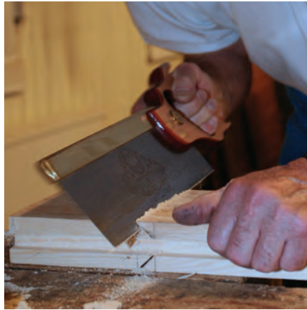
Bild 25. Därefter sågas rakt ner mellan de två första sågspåren. Till detta används en ryggsåg.
