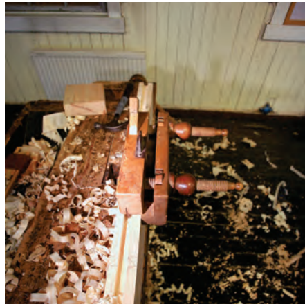
Bild 22. När arbetet med tapphålen i sidstyckena är klart fortsätter Sjur med tappstyckena. Det tidigare inställda strykritsmåttet används och tapparna ritsas på tvärstyckenas kanter och ändar. Eftersom tvärstyckenas tappskuldra ska kontraprofileras mot en 45 graders fasning på sidstyckena ritas vinkel på tvärstyckenas kant. Därefter nothyvlas styckena.
