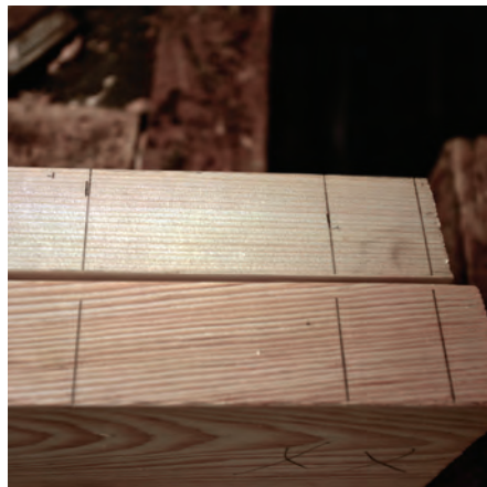
PÅRITNING OCH SAMMANSÄTTNING Bild 14. Nästa steg är påritning för tappar och tapphål. Först märks sidstyckenas kärnsida och vilken ände som ska vara nedåt (roten) med x x. Kanten som ska vändas inåt märks med x. Därefter läggs sidstycket på vid yttermättet och ramens innermått märks. Innermättet plus sidstyckenas bredd ger dörrbladets bredd-yttermått. Sedan bestäms tapphållets bredd och placering. Detta ger även notspårets djup.
