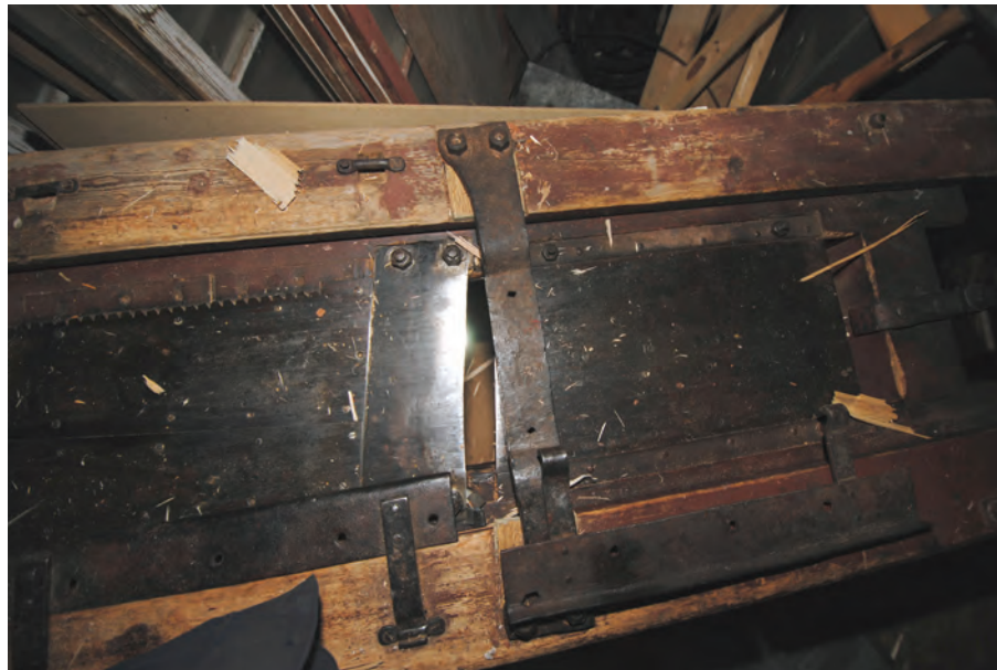
Bild 11. Hyvelstålet är snedtält för att möjliggöra hyvling med stående årsringar.
