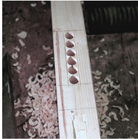
Bild 20. Därefter borras resten mellan de första två hålen. Hålen borras till halva djupet därefter vänds stycken och borras klart. Tapphålen rensas med ett brett stämjärn längs med fibrerna och ett smalt i tvärriktningen.
