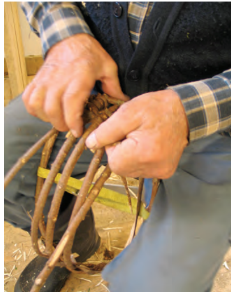
Bilde 26. Når det finnes plass til ett nytt sett ribber settes de inn, først på den ene siden, så på den andre siden av kurven. Ribbene setter han inn vekselvis med den tykke enden og så den tynne enden.
