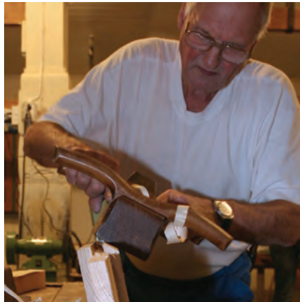
Bild 27. Fasen (profilen) på ramstyckena insida hyvlas med oxhyvel och rubank.
