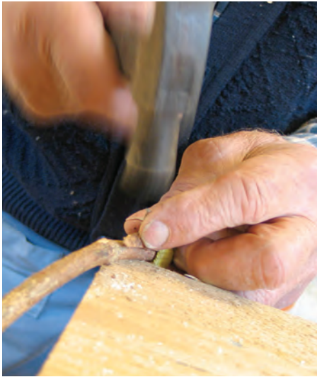
Bilde 6. Når ringen har fått sin form, festes skjøten med stifter (nabb).
