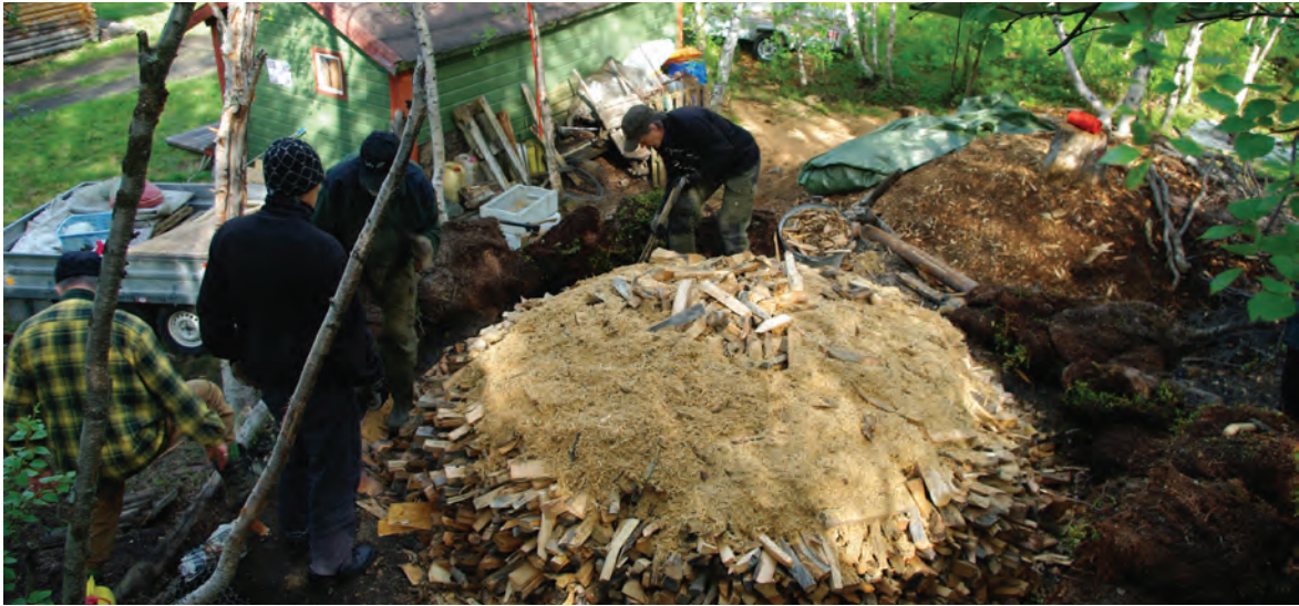
Bild 13. Över spillretserna läggs sågspån. Det görs för att kunna kontrollera draget i milan.
