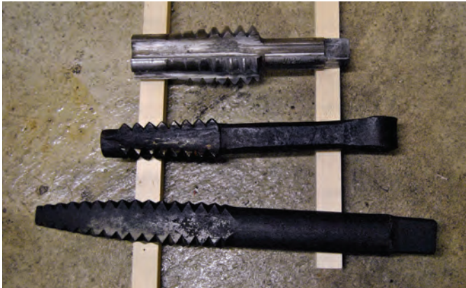
Bild 8. Överst: Maskintillverkad gängtapp. Mitten: Handsmidd och filad gängtapp. Nederst: Äldre svarvad och fräst gängtapp.
