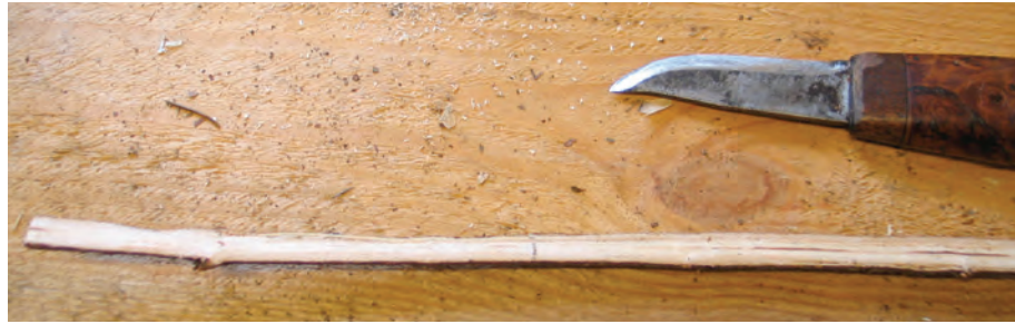
Bilde 12. Georg markerer ett felt på 78 cm, midt på den 120 cm lange "midtribben".
