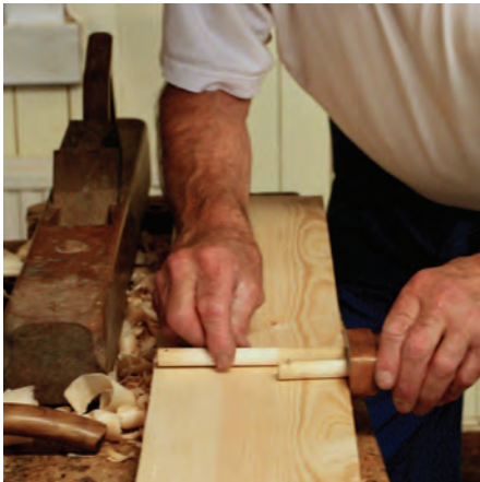
Bild 10. Styckenas breddmått ritsas på med strykritsmått.
