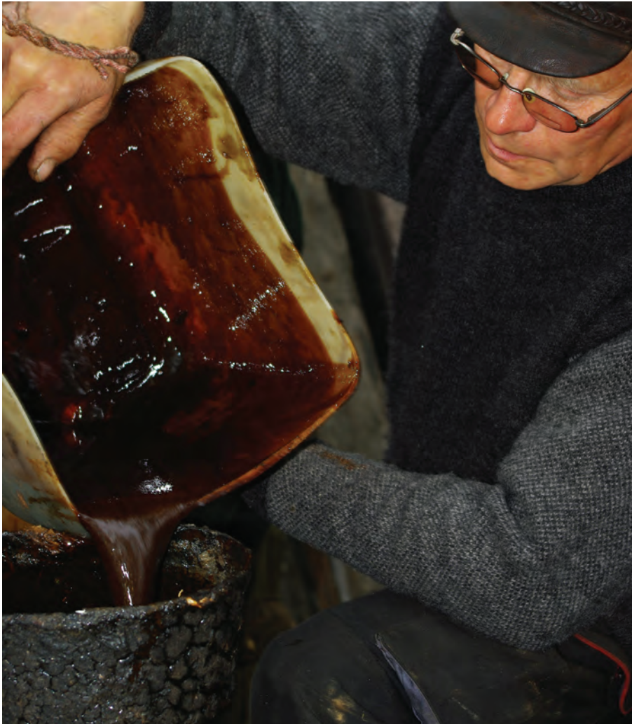
Bild 18. Efter att det obundna vattnet tagits bort med hjälp av en hävert, tappar Arne Graven upp den nya tjäran som bränts.
