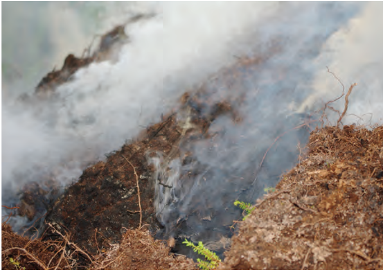
Bild 16. Sverre håller koll på rökens färg. Vid blå rök brinner tjäran och vit rök är ånga från ved och torv.
