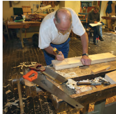
Bild 23. Utifrån denna 45 graders märkning ritas tappskuldran på styckets sida. Blyerstritan förstärks genom att skära i denna med ett stämjärn. Först mot en klots som hålls mot blyerstmarkeringen. Sedan skärs ett spår med stämjärnet som anlägg för sågen.
