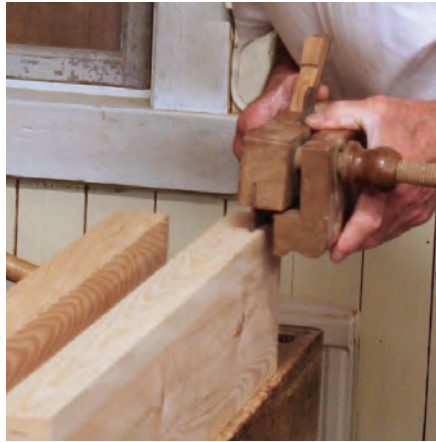
Bild 17. Nothyvelns anhåll hålls mot de tidigare kryssmärkta sidorna och ett lätt hyveltag tas för att få en markering att ställa in strykritsmättet efter.
