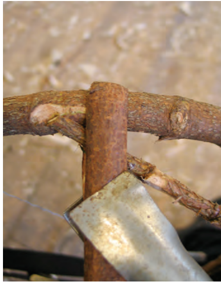
Bilde 16. Georg tar ett smalt band og stikker inn i åpningen mellom ribben og dens tynnede ende. Bandet stikkes inn fra høyre, sett utenifra.
