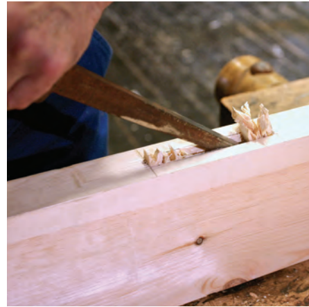
Bild 21. Sjur ombeds att hugga ett tapphål med lockbettel. Han fördrog annars att borra och rensa hålet med stämjärn. Huggningen görs med ömsom lodräta och ömsom sneda hugg mot de lodräta huggningarna. Hålen rensas emellanåt med ett stämjärn. Hålen huggs till halva djupet och sedan vänds stycket och tapphålet färdigställs.
