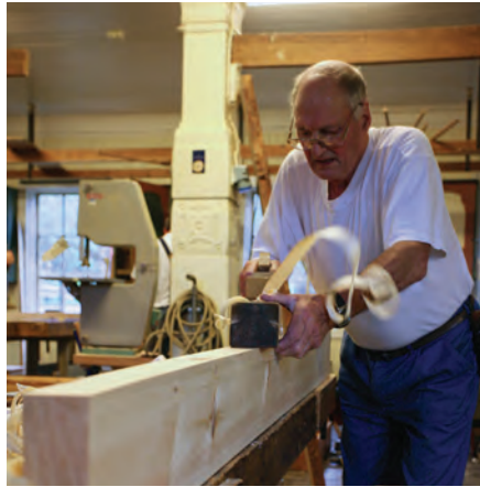
Bild 9. Riktningen avslutas med en rubank. När man ser Sjur hyvla blir det uppenbart hur skicklig han är och att han har hyvlat mycket för hand.
