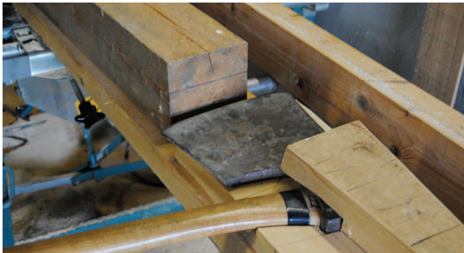
Billede 10. Stativet som Oddbjørn konstruerede for at på en effektiv måde tilvirke alle tapper. Foto: Ulrik Hjort Lassen
