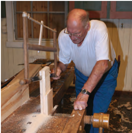
Bild 26. Tapparna slitsas med en grindsåg. Sjur sågar på höger sida och vänder sedan stycket för att slippa såga på den vänstra sidan.
