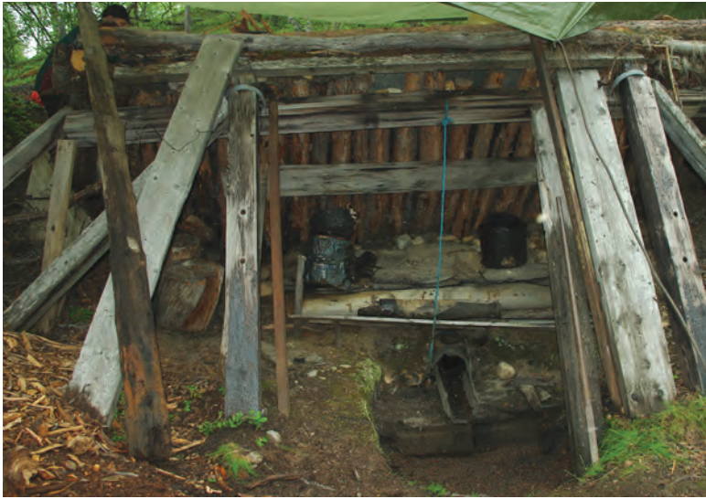
Bild 7. Tjärmilan står i en sydsluttning och på nedre sidan är den "stämpad". Tappröret som är cirka 1,5 m långt leder ut tjäran i slänten.
