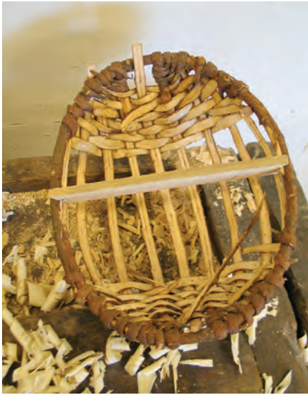
Bilde 27. Avstiving: Noen ganger er det behov for å sette inn en pinne som avstiver, for å holde fasongen (vidden) i kurven eller en hyssing (ståltråd) for å motvirke en eventuell vridning.
