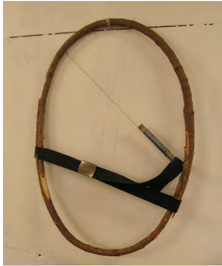
Bilde 7. For å kontrollere ringen henger han den opp på veggen, når den slutter tett inntil veggen og formen er god, da er den klar. Hvis den ikke er plan, bøyer han og former den til den er ok.
