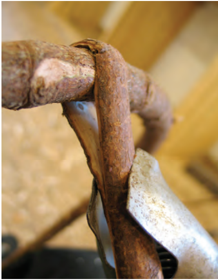
Bilde 15 Ribben ved posisjon 1. Han fører det tynnede endestykket tett rundt kantringen, og holder det fast til innsiden av ribben med en klemme. Deretter vender han ringen og fester ribbe nummer to på samme måten i motsatt ende, posisjon 2. Nå ligger ribbene slik at det er en tynn ende og en tykk ende ved hver kortsida.
