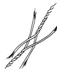
Fig 2: vid skarvning så lägger en de två garnbitarna så här.
