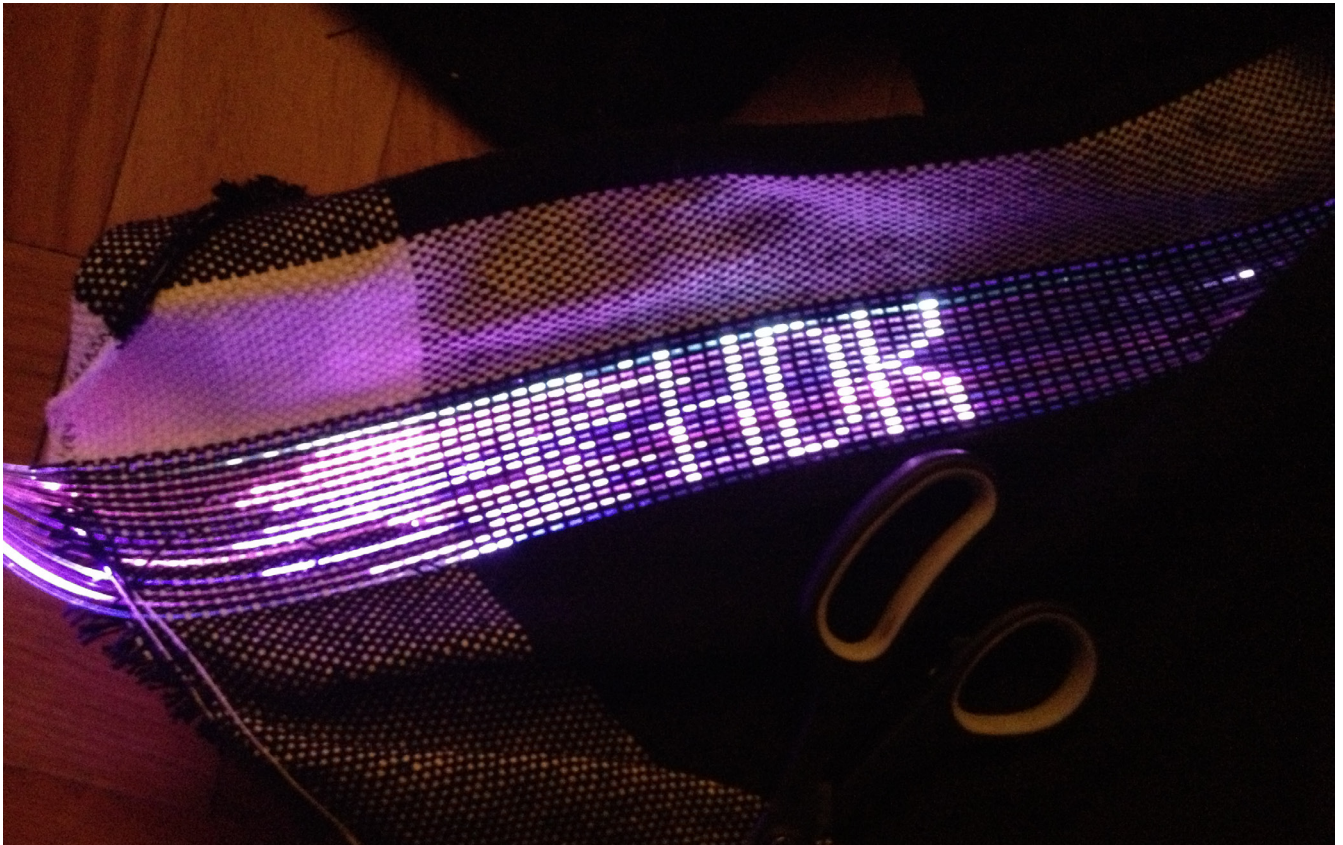
Behandlad fiberoptik lyser betydligt starkare. HDK texten har skrapats fram genom att ta bort cladding på fiberoptiken
