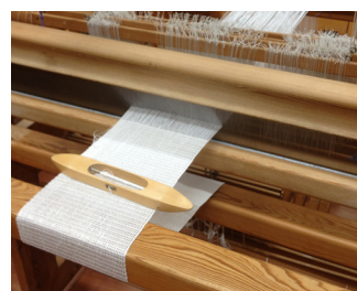
Bilder under vävningsprocessen, observera att fiberoptiken spändes avskilt från naturfibern
