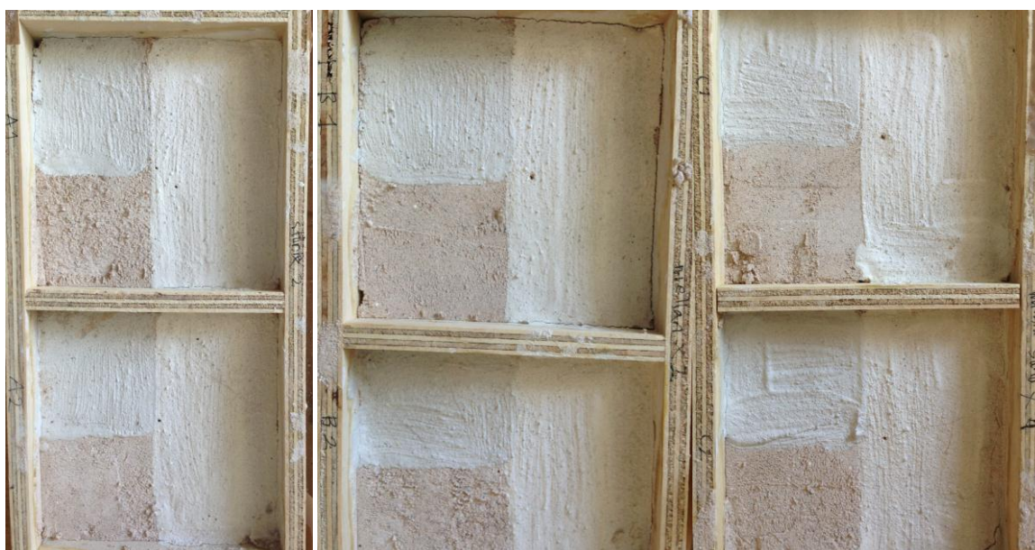
Figur 6: Ovan i bild redovisas de tre prover som konsoliderats under värme (A1, B1 och C1), nedan i bild redovisas de tre prover som konsoliderats i rumstemperatur.
