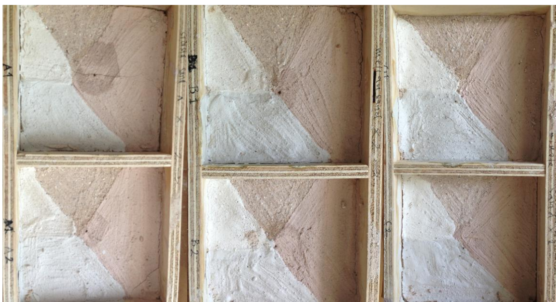
Figur 5: Ovan i bild redovisas de tre prover som konsoliderats under värme (A1, B1 och C1), Nedan i bild redovisas de tre prover som konsoliderats i rumstemperatur.
