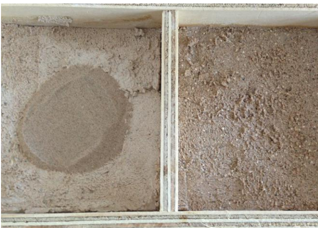
Figur 3: Till vänster i bild arriccio som låtit torka i fjorton dagar med en hög sand av den mest finkorniga varianten som ska imitera en ökad porositet, till höger i bild nyslagen intonaco.
