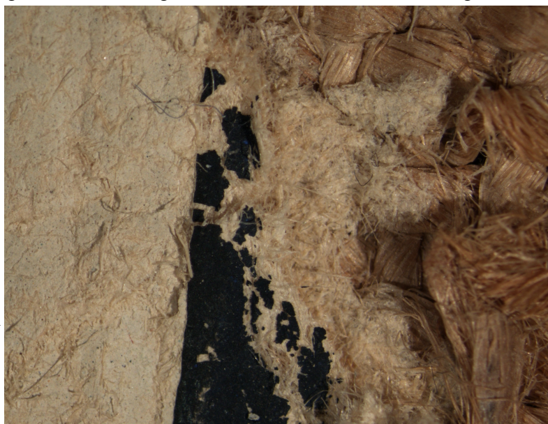
Fig. 15. Detalj, brottyta, tydlig ytbestrykning, 10x förstoring i arbetsmikroskop
