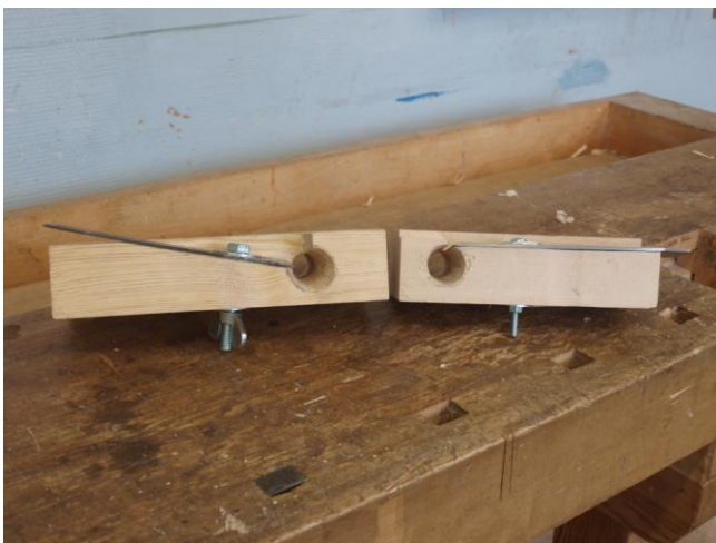
Till vänster tränegel tillverkad efter illustration i " Ships' fastenings: from sewn boat to steamship ". Till höger egen konstruktion med annan skärvinkel
