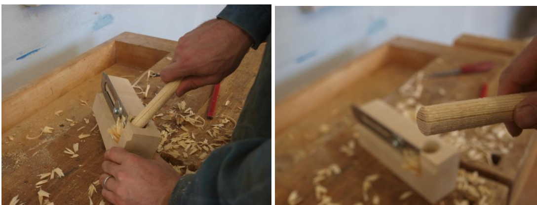
Bilderna visar tränegelns vridning i tränegelhyveln
