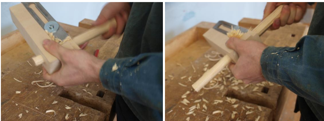
Bilderna visar tränegelns vridning i tränegelhyveln
