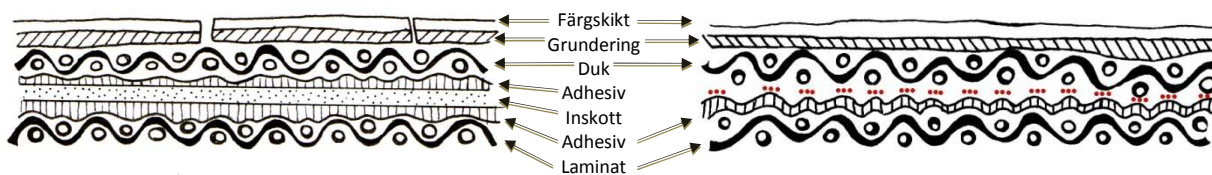
Bild 3. Schematisk skiss över en laminering med inskott (vänster) samt laminering med nap-bonding (höger) där bindning markeras med rött
