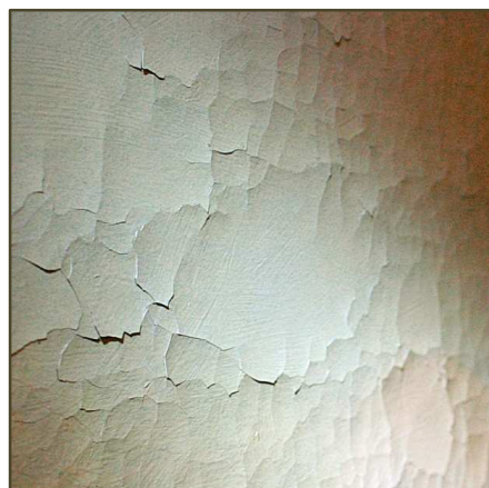
Bild 5. GHM 20373. Göteborgs Stadsmuseum. Detalj. Objektet uppvisade omfattande skålbildning tillsammans med allvarlig bristfällig bindning
