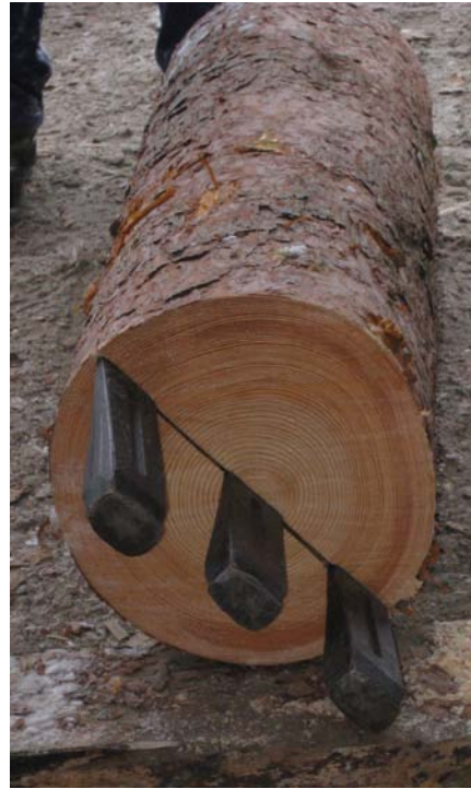
Figur 44. Kilar slogs in i den påbörjade sprickan. Härfter barkades stocken på sidorna där de förmodade sprickorna skulle löpa. Detta för att lättare följa spräckningen.
