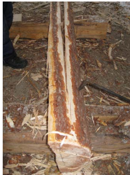
Figur 46. Halvklovan sattes fast med timmerhake och klövs ytterligare en gång. Träkilar slogs in från änden och med hjälp av baksidan av yxan slogs dessa genom halvklovan medan man själv gick baklänges grensle över halvklovan.
