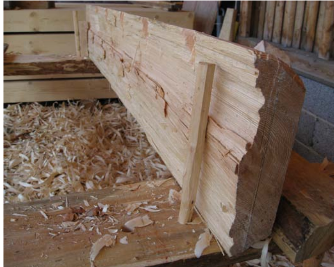
Figur 47. En planka gick inte att spräcka till "färdigt mått" utan jag fick bila bort den vresiga ytan närmast mörgen.
