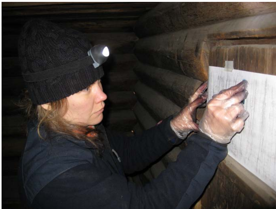
Figur 5. Dokumentation av verktygsspår med hjälp av frottage. Foto J. Jamte 2010
