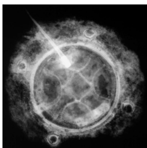
Figur 3. Ett korroderat metallfynd kan förefalla något intetsägande, men en röntgenbild kan avslöja intressanta detaljer.
