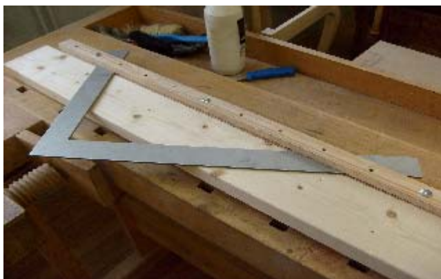
Bild 11. Vinkel med list inställd på positionerna 38° och P.2, är till för påritning av Grad/kälsparrar.
