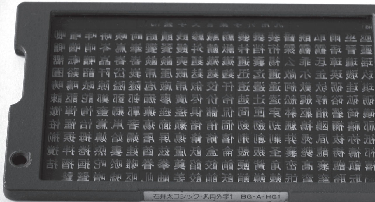
Figur 18 | fotosättarna lagrades typsnitten på glasskivor som kunde flyttas med elektronik för att få fram rätt tecken.
