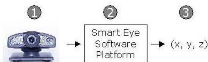
Bild 3.1: Schematisk bild av ett "Smart Eye" system. (Källa: SmartEye.se)
