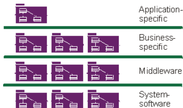
Figur 3. Illustrerar komponentbaserad arkitektur i skikt. Mapparna är delsystem indelade i skikt, i mapparna visas komponenter (RUP, 2001).
